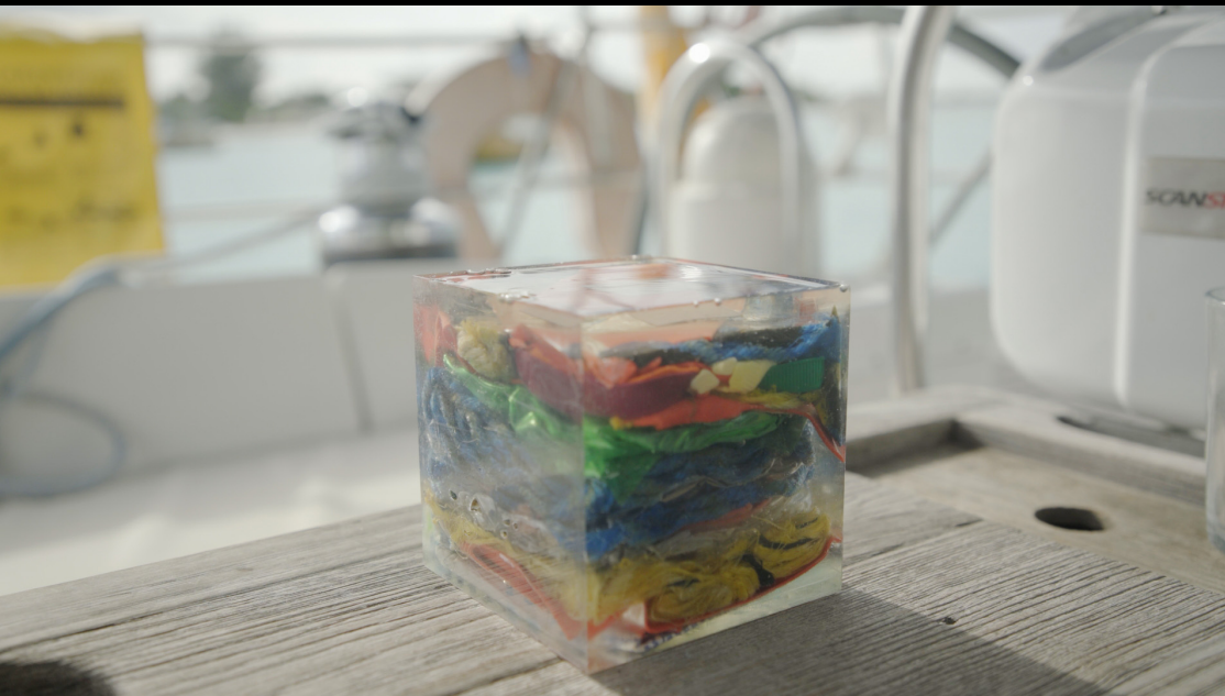
G-Cubes sind Würfel aus Abfall gepresst und in Kunstharz eingegossen.
